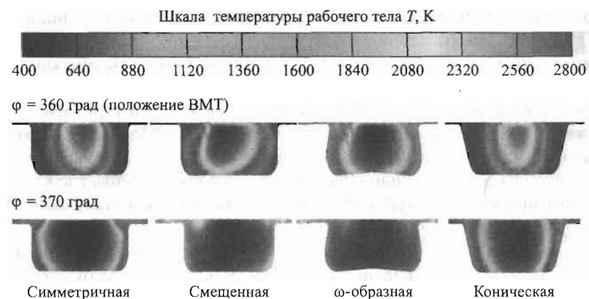
Рис. 10.6. Изменение локальных значений температуры рабочего тела в различные моменты рабочего цикла в зависимости от формы КС
