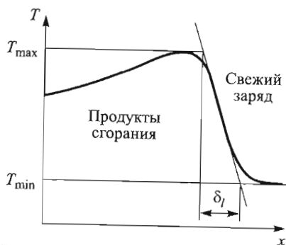
Рис. 10.1. К определению толщины фронта ламинарного пламени
