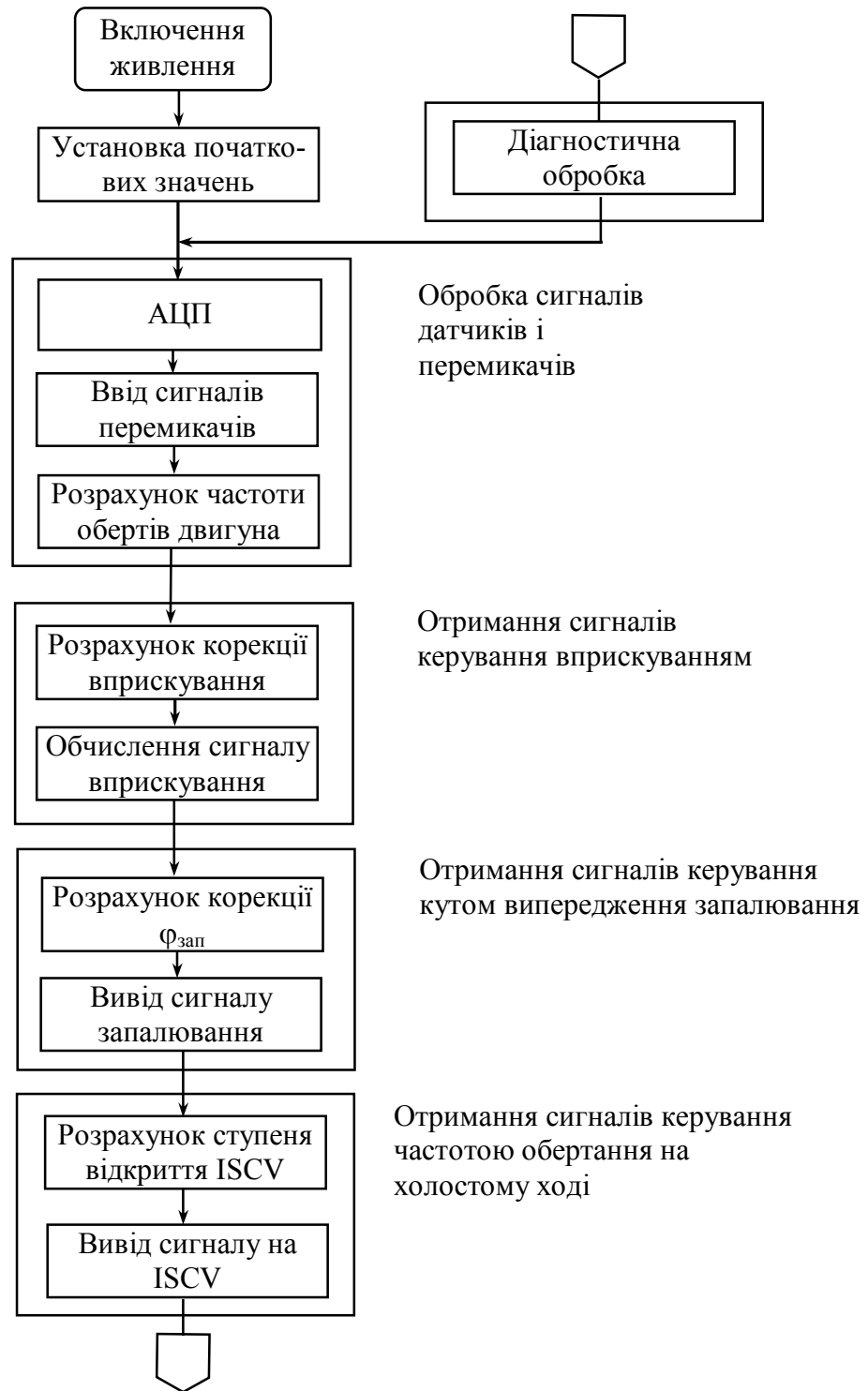
Рисунок 6.11 – Укрупнена блок-схема програми управління паливоподачею ДВЗ: ISCV – клапан керування частотою холостого ходу
