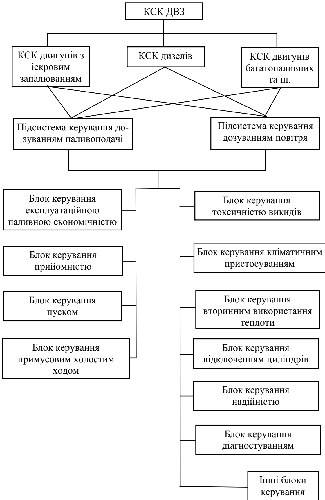
Рисунок 2.16 – Структура сучасних КСК ДВЗ
