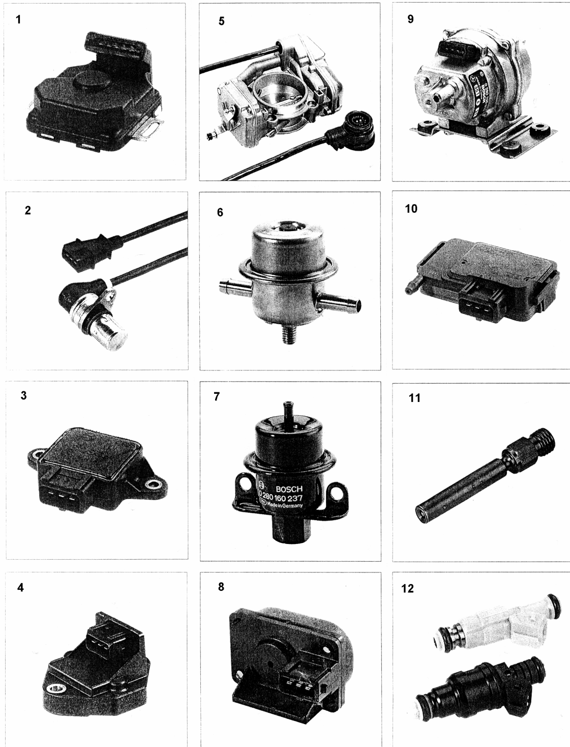
Рисунок 3.69 – Датчики та виконавчі пристрої сучасної КППСК паливоподачею (Motronic) (початок):
