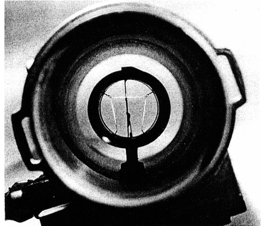
Рисунок 3.34 - Термоанемометричний датчик витрати повітря [6]:
