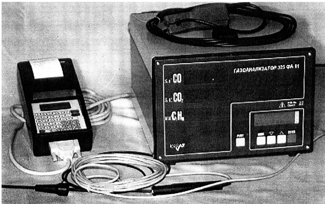
Рисунок 5.14 – Газоаналізатор 325 ФА01 (Україна, фірма “Укрналіт”)
