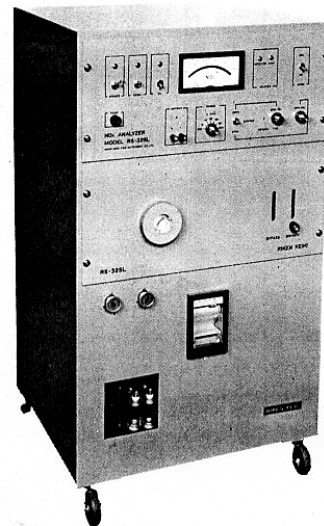
Рисунок 5.18 – Хемілюмінесцентний аналізатор RX-777 із вбудованим комп'ютером для контролю ВГ двигуна автомобіля, “Рікен Кейкі” (Японія)
