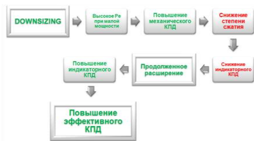
Рис. 3.9. Схема повышения топливной экономичности варианта двигатель-эспандер
