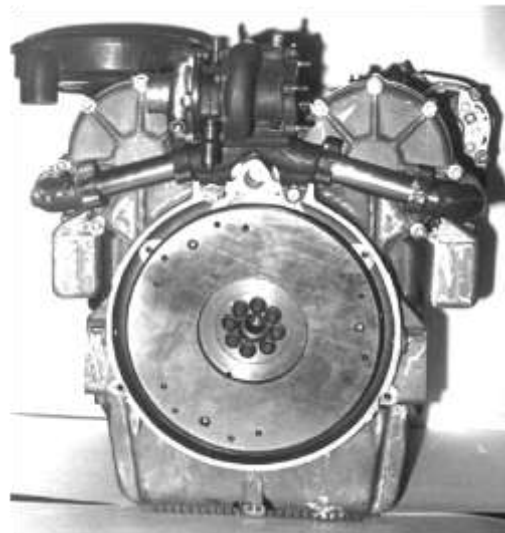
Рис. 5.2. Траверсный дизель ТБ-48 ( iV_h = 1,9 л) на базе двигателя Elko 3.82.92Т фирмы Elsbett-Konstruktion (Австрия)
