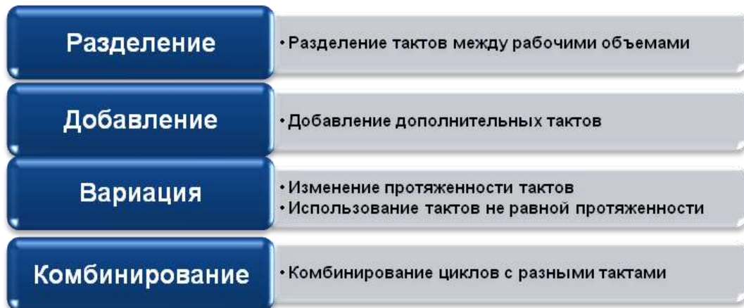
Рис. 1.2. Направления и методы модифицирования рабочего цикла
