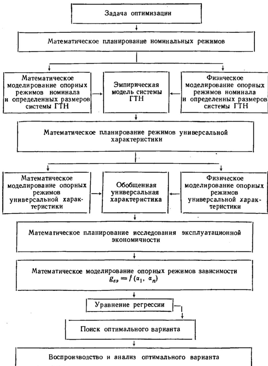
Рис. 18. Схема оптимизации определяющих параметров цикла ДТУ.
