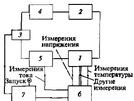
Рис. 7.42. Схема измерений теплофизических свойств с использованием нагрева образца импульсом электрического тока
