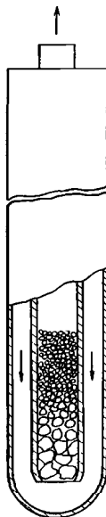
Рис. 7.40. Схема рабочего участка для измерений вязкости газов по методу потока через пористую среду
