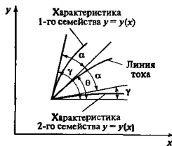
Рис. 1.63. Характеристики (линии возмущения) плоского сверхзвукового потока
