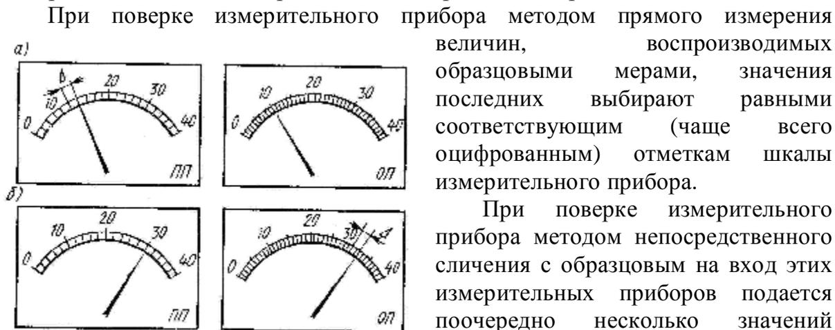
Рис. 15.2. Способы поверки измерительных приборов
