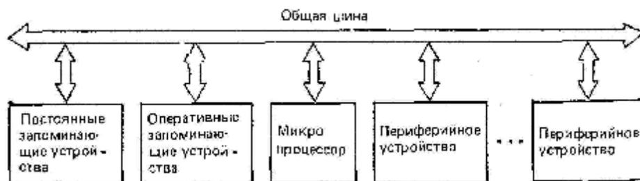
Рис. 14.1. Структурная схема микроЭВМ
