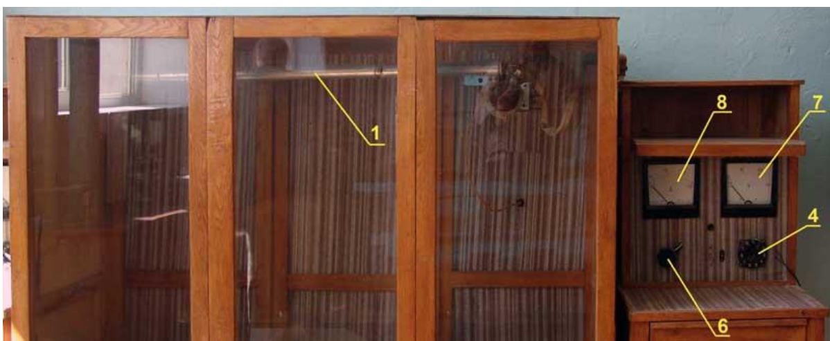
Рис. 3.9. Установка для дослідження вільно-конвективної тепловіддачі горизонтального довгого циліндра
