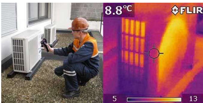
Рис. 5.8. Отримання поля радіаційних температур за допомогою тепловізора
